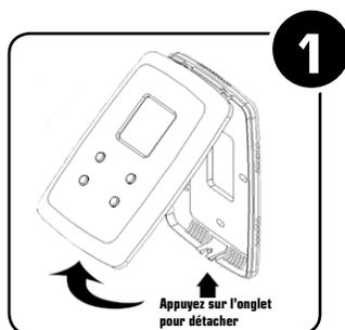
**1** Détachez le module avant de la plaque de montage en appuyant sur la languette (située au bas du boîtier).
