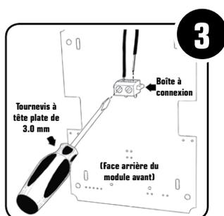
**3** Insérez les fils de transmission (2) dans le bornier, situé sur la face arrière du module avant. Sécurisez-les en place en serrant les vis du bornier à l'aide d'un petit tournevis à tête plate de 3,0 mm (non fourni).
