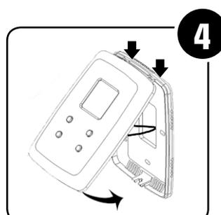
**4** Fixez le module avant sur la plaque arrière, en insérant tout d'abord la partie supérieure du module avant dans les attaches supérieures, puis en pivotant le module en appuyant sur le bas, jusqu'à ce que vous entendiez un « clic ». Vérifiez que le système de ventilation fonctionne.
