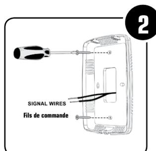
**2** Guidez les deux (2) fils de commande dans l'ouverture centrale de la plaque de montage et montez cette dernière soit sur le boîtier d'un appareil électrique standard ou directement sur le mur à l'aide de vis. Au besoin, utilisez des dispositifs d'ancrage au mur.
